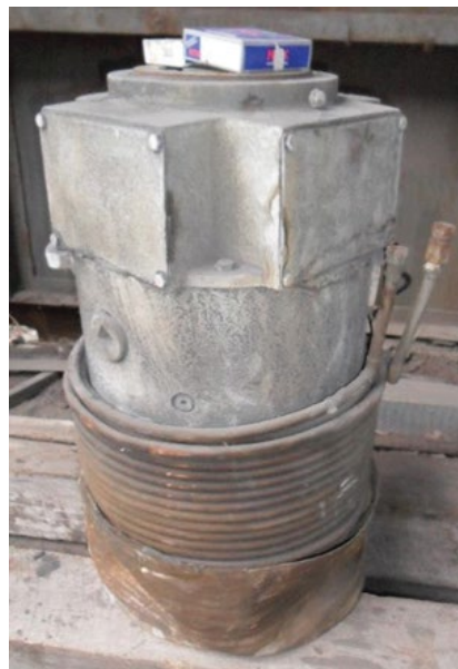
Figura 2. Motor de CD original con serpentín de agua externo alrededor de la parte central.
